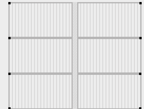
Pérgola compartiendo columnas con estructura de acero central
